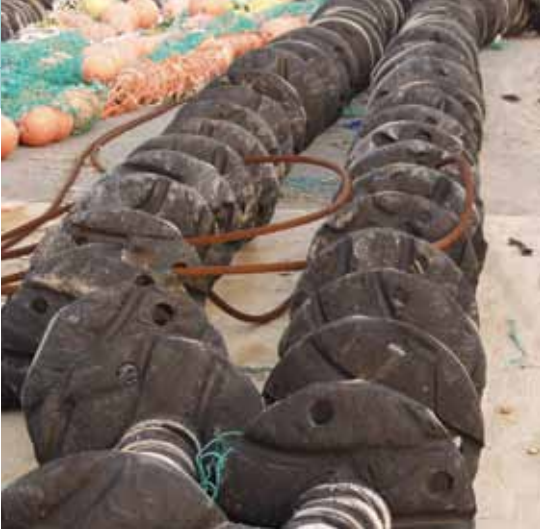
Sistema de tren de bolos utilizados en la pesca de arrastre de fondo.
